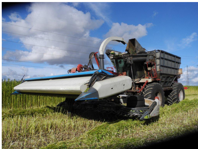
Nyudviklet hampehøster fra Dun Agro, Holland, kan strippe hampeblade og frø ved skårlægning af hampen. Demonstration af hampehøsteren foregik hos hampeavl Jørgen Heggelund, Bjæverskov ved hampehøsten 2012. (1). (Klik på billedet for stor udgave) Fotograf: Tomas Fibiger Nørfelt, Videncentret for Landbrug, Økologi.
